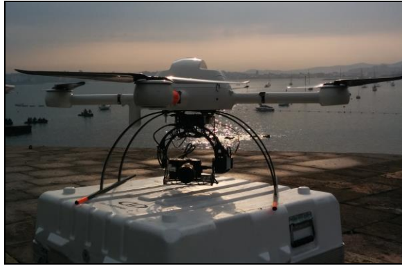
Figure 1 : le drone md4-1000 et son appareil photo SONY NEX 7
